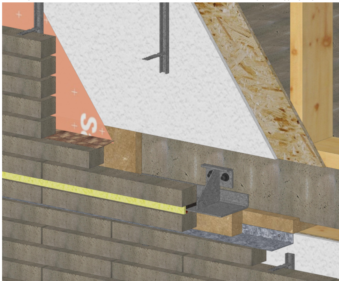
Figure 4 : Cas d'une FOB interrompue (structure béton) – Ecran thermique de type plaque
