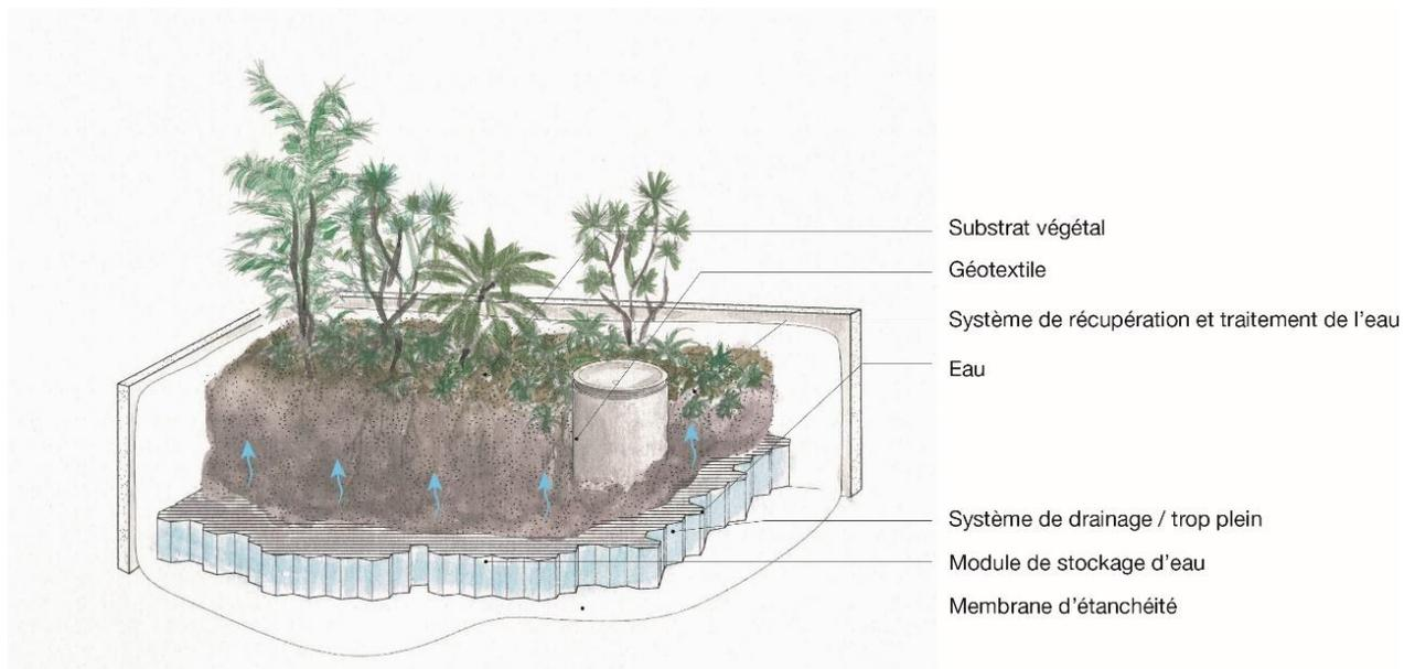
Croquis de principe du JPU avec une alimentation par les EP de ruissellement :
