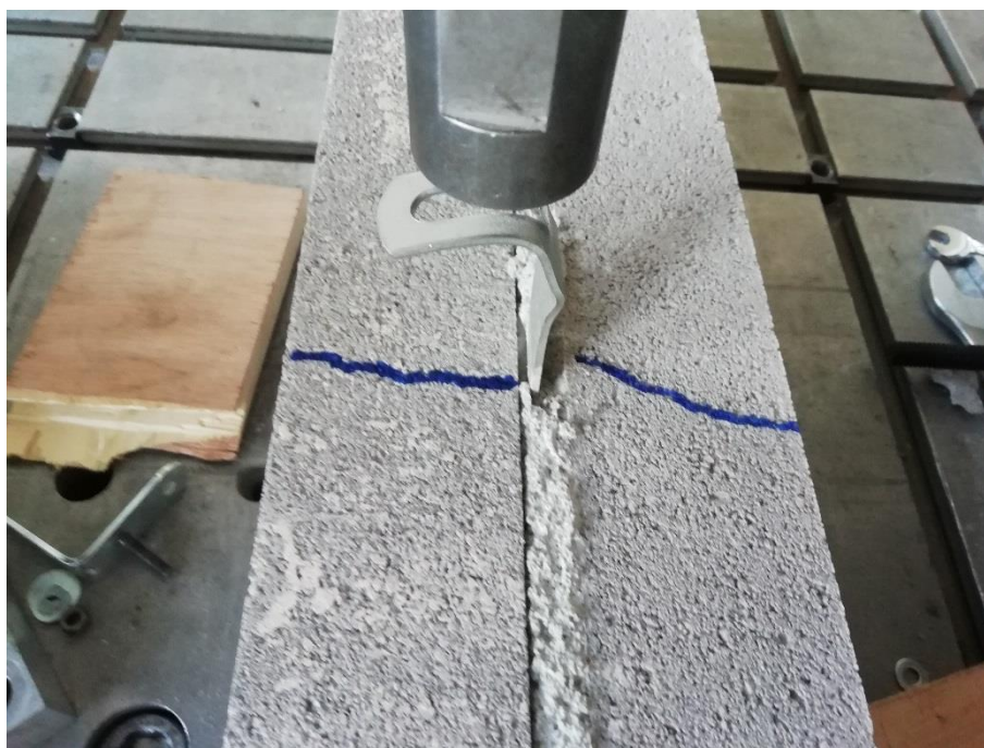
Figure 7.3 : Représentation du mode de ruine – rupture de la brique
