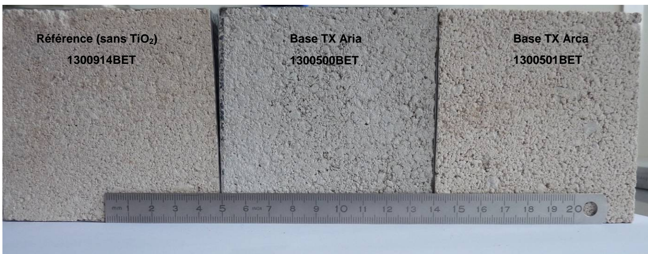
Photo1 Briques béton Référence (sans TiO 2 ) et formulées avec du TX Aria ou du TX Arca
