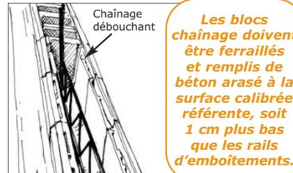
Les blocs chaînage doivent être ferrillés et remplis de béton arasé à la surface calibrée référente, soit 1 cm plus bas que les rails d'emboitements.
