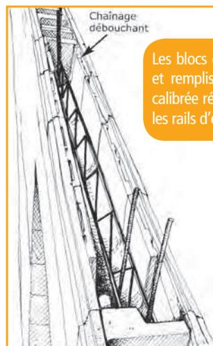
Les blocs chaînage doivent être ferrillés et remplis de béton arasé à la surface calibrée référente, soit 1 cm plus bas que les rails d'emboîtements.
