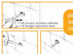
positionner les fixations au centre des parties creuses des blocs
