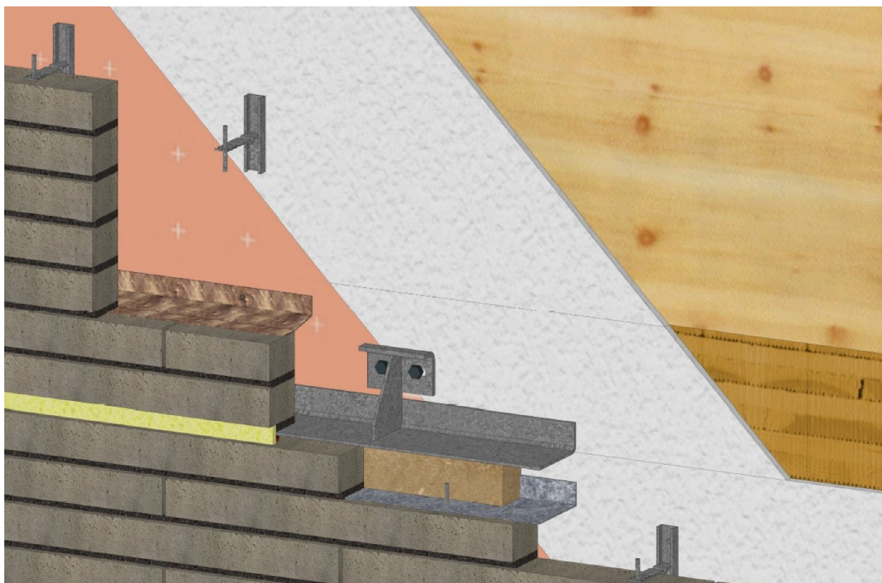
Figure 3 – Cas d'un mur porteur en panneau structural massif bois (p.ex. Structure CLT) – Ecran thermique de type plaque
