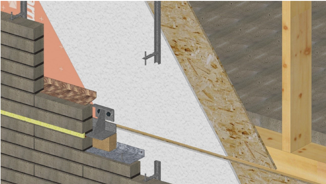
Figure 1 – Cas d'une façade à ossature bois non porteuse filante (structure béton) – Ecran thermique de type plaque
